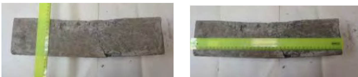
Рис. 1. Железобетонные балки после испытаний импульсной нагрузкой
