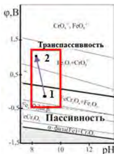
Рис. 3. Переход из пассивного в транспассивное состояние защитной пленки при уменьшении рН и увеличении электродного потенциала
