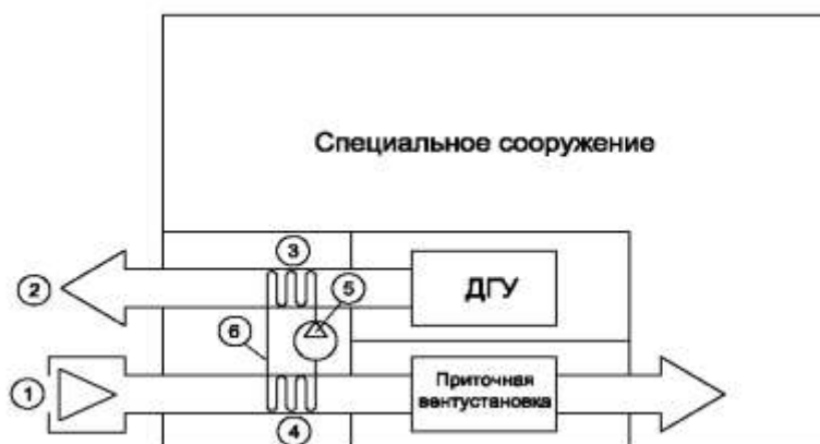
Рис. 2. Схема утилизации теплоты выхлопных газов ДГУ:
