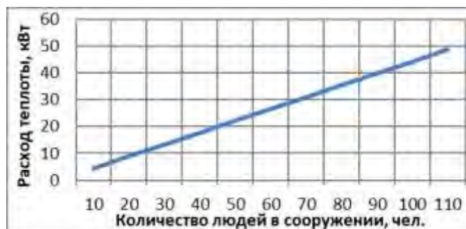
Рис. 1. Расход теплоты для нагрева наружного приточного воздуха
